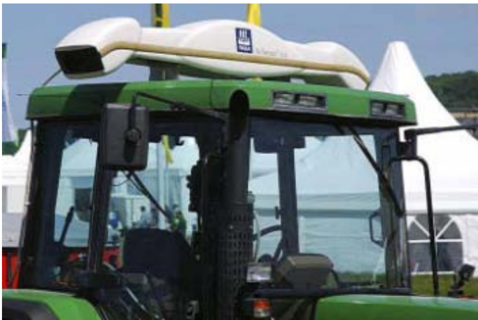
Figure 24: Yara N- Sensor ALS mounted on a tractor's canopy.
